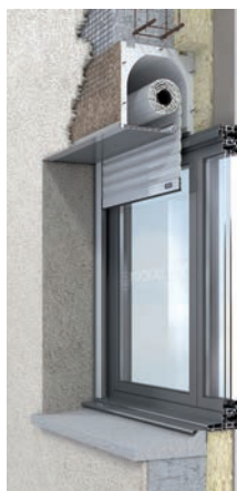
Tablier et coulisses proche de la fenêtre (enroulement extérieur)
