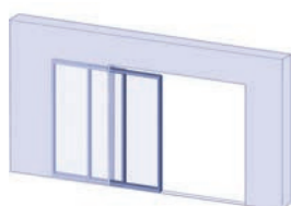
2 vantaux, refoulement du même côté à gauche
